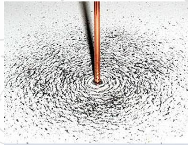
Vasreszelék az áramátjárta vezető körül.
